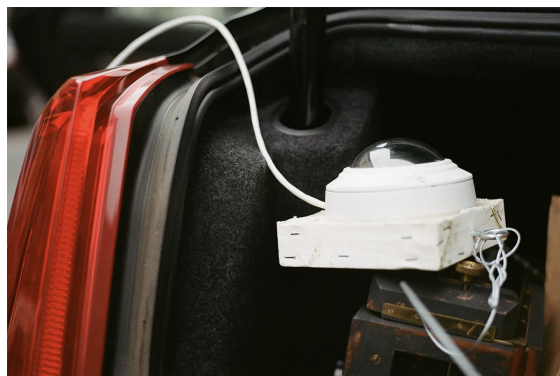
图 2-71 Wordcar 的眼睛是一台 Axis M3007 监控摄像机.2017 79
